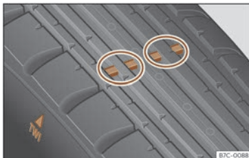
Fig. 205 Perfil del pneumàtic: Indicadors de desgast.
