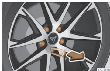
Fig. 32 Roda: caragols de la roda amb caputxons.
