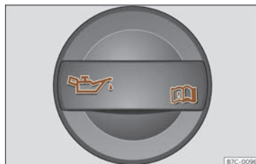
Fig. 198 Tap de la boca d'ompliment d'oli del motor al compartiment del motor.
