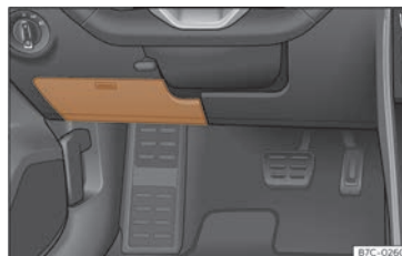
Fig. 45 Vehicles amb volant a l'esquerra: tapa de la caixa de fusibles sota del tauler d'instruments del costat del conductor
