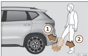
Fig. 80 Porta del maleter amb obertura controlada per sensor (Easy Open).
