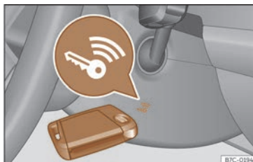
Fig. 135 A la dreta de la columna de direcció: arrencada d'emergència.
