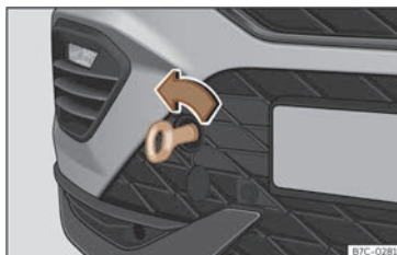
Fig. 42 A la part dreta del para-xocs davanter: argolla de remolc enroscada.
