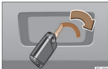
Fig. 82 Detall del maleter: desbloqueig d'emergència.
