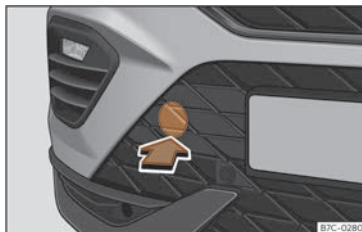
Fig. 41 A la part dreta del para-xocs davanter: retirar la tapa.
