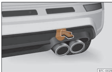
Fig. 43 A la part dreta del para-xocs del darrere: retirar la tapa.
