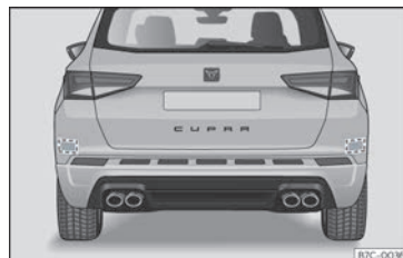
Fig. 227 Vista posterior del vehicle: zones dels sensors de radar.
