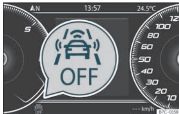
Fig. 213 A la pantalla del quadre d'instruments: indicació de Front Assist desactivat.
