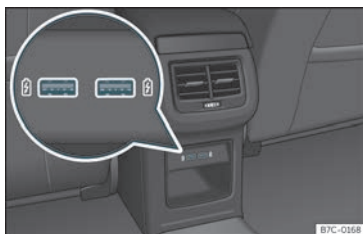
Fig. 196 Part posterior consola central: connectors USB.
