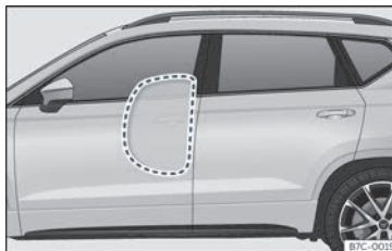
Fig. 20 Coixins de seguretat laterals completament inflats a la banda esquerra del vehicle.
