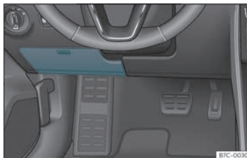
Fig. 44 Vehicles amb volant a l'esquerra: tapa de la caixa de fusibles sota del tauler d'instruments del costat del conductor
