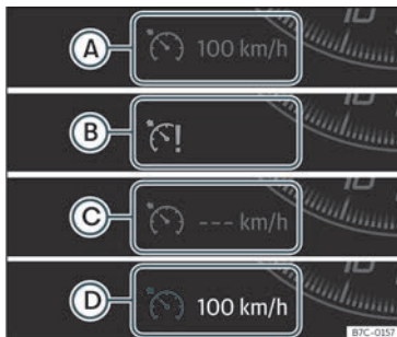
Fig. 206 Pantalla del quadre d'instruments: indicacions d'estat del GRA.
