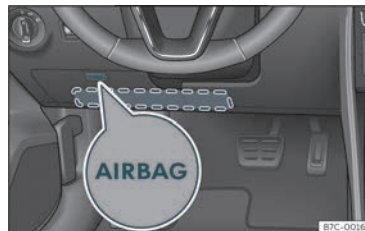
Fig. 17 Al costat del conductor: ubicació del coixí de seguretat per als genolls.
