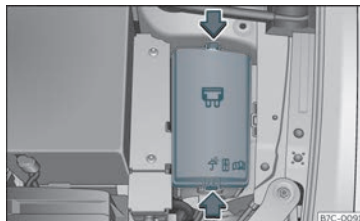
Fig. 46 Al compartiment del motor: tapa de la caixa de fusibles.
