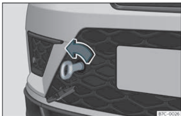
Fig. 41 A la part dreta del para-xocs davanter: argolla de remolc enroscada.
