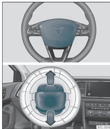
Fig. 13 Coixí de seguretat del conductor al volant. »
