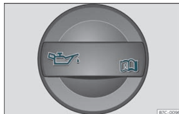
Fig. 259 Tap de la boca d'ompliment d'oli del motor al compartiment del motor.
