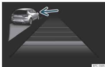
Fig. 220 A la pantalla del quadre d'instruments: ACC actiu, vehicle detectat per l'esquerra
