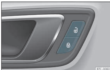
Fig. 71 Porta del conductor: commutador del tancament centralitzat.
