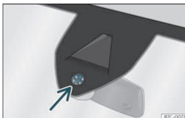
Fig. 94 Superfície sensible del sensor de pluja.
