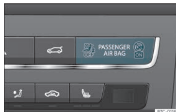
Fig. 16 Tauler d'instruments: indicador de control de la desactivació del coixí de seguretat de l'acompanyant.
