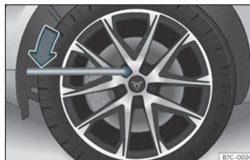
Fig. 33 Canvi de roda:afluixar els caragols de roda.
