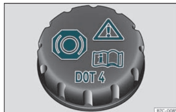
Fig. 262 Compartiment del motor: tap del dipòsit del líquid de frens.
