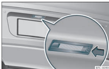
Fig. 52 En el para-xocs posterior: llum de matrícula.
