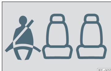
Fig. 5 Quadre d'instruments: indicació de plaça posterior esquerra ocupada i cordat el cinturó corresponent.
