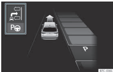
Fig. 234 A la pantalla del quadre d'instruments: visualització del sistema d'aparcament assistit amb visualització reduïda.
