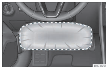
Fig. 18 Al costat del conductor: radi d'acció del coixí de seguretat per als genolls.
