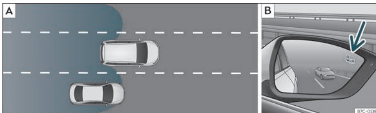
Fig. 229 Representació esquemàtica: [A] Situació en un avançament i incorporació posterior al carril dret. [B] Indicació de l'assistent d'angle mort al retrovisor exterior dret.
