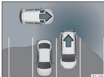
Fig. 230 Representació esquemàtica de l'assistent de sortida de l'aparcament: zona vigilada al voltant del vehicle que està sortint de l'aparcament.
