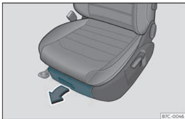
Fig. 119 Portaobjectes sota dels seients davanters.
