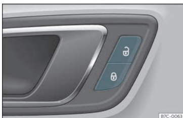
Fig. 71 Porta del conductor:commutador del tan-cament centralitzat.
