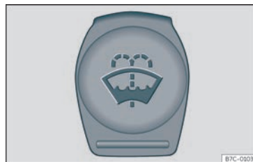
Fig. 263 Al compartiment del motor: tap del dipòsit de l'eixugavidres.
