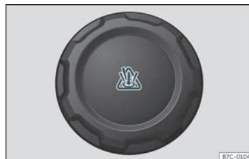
Fig. 261 Compartiment del motor: tap del dipòsit d'expansió del líquid refrigerant.
