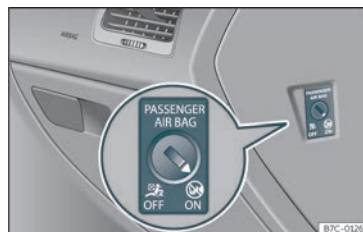
Fig. 15 Commutador amb clau per activar i desactivar el coixí de seguretat de l'acompanyant.
