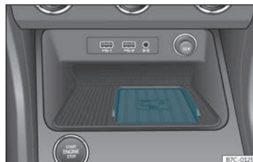
Fig. 197 A la consola central: allotjament per a la connexió del telèfon mòbil.
