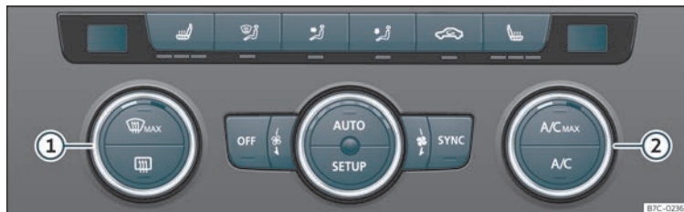
Fig. 123 A la consola central: comandaments del Climatronic
