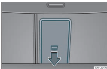
Fig. 116 Al maleter: obertura de la trapa.
