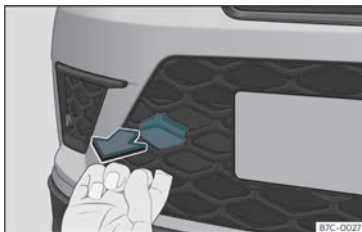
Fig. 40 A la part dreta del para-xocs davanter: retirar la tapa.
