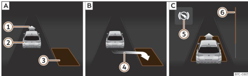
**Fig. 176** En la pantalla del cuadro de instrumentos: aparcarse en línea. **[A]** Buscar un hueco de aparcamiento. **[B]** Posición para aparcarse. **[C]** Maniobrar.
