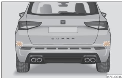
**Fig. 148** Vista trasera del vehículo: zonas de los sensores de radar.
