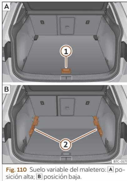
**Fig. 110** Suelo variable del maletero: **A** posición alta; **B** posición baja.
