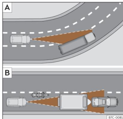
**Fig. 159** **A**) Vehículo en una curva. **B**) Motociclista circulando por delante fuera del radio de acción del sensor de radar.
