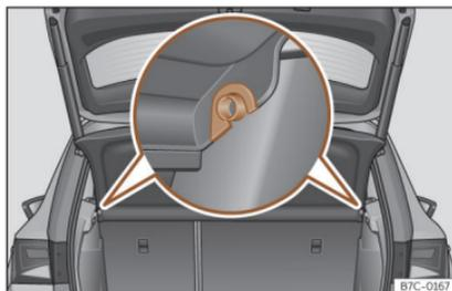
**Fig. 107** En el maletero: desmontar y montar la bandeja.
