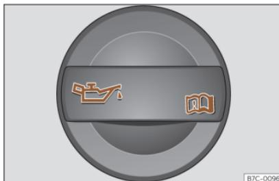
Fig. 201 Tapón de la boca de llenado de aceite del motor en el vano motor.
