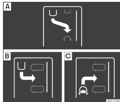
**Fig. 175** En la pantalla del cuadro de instrumentos: indicación de los modos de aparcamiento.
