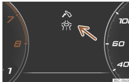
Fig. 53 Indicación de la asistencia para una conducción ecoeficiente (representación esquemática).
