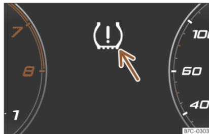
Fig. 210 Cuadro de instrumentos: aviso de pérdida de presión de los neumáticos.
