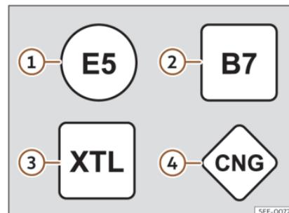
**Fig. 194** Identificación de los combustibles según Directiva de la Unión Europea (UE) 2014/94/
