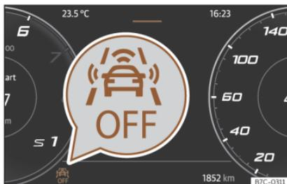
**Fig. 154** En la pantalla del cuadro de instrumentos: indicación de Front Assist desactivado.
