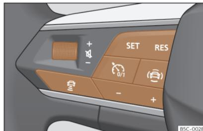
Fig. 156 En el volante multifunción: botones para manejar el ACC
