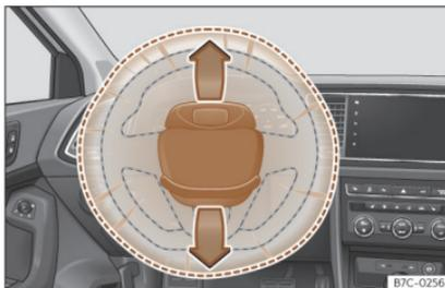
Fig. 13 Airbag del conductor en el volante.
