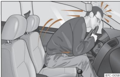
**Fig. 7** El conductor que no lleve puesto el cinturón de seguridad se verá lanzado hacia delante.
