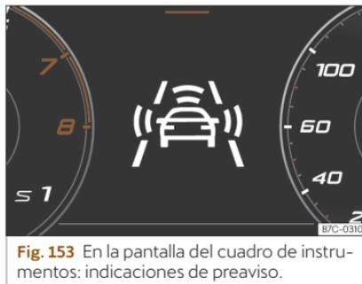
Fig. 153 En la pantalla del cuadro de instrumentos: indicaciones de preaviso.
