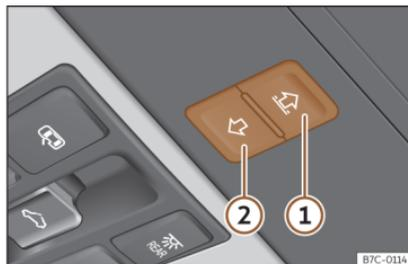
**Fig. 85** En el revestimiento interior del techo: teclas de la cortinilla parasol.
