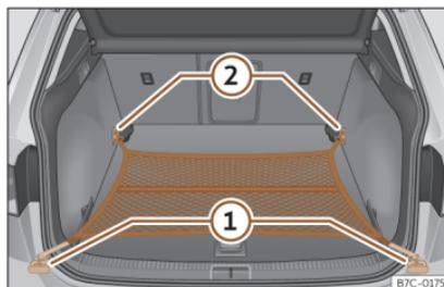
**Fig. 113** En el maletero: bolsa de red enganchada a ras del suelo.
