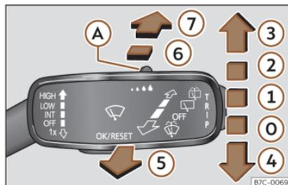
**Fig. 91** Manejo del limpiaparabrisas y limpialuneta.
