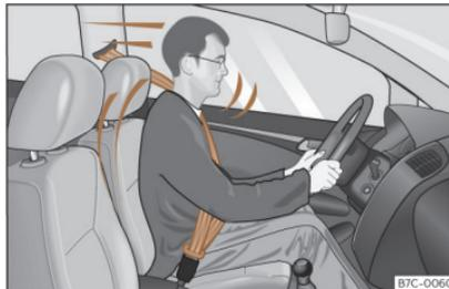
**Fig. 6** Los conductores que lleven el cinturón de seguridad correctamente abrochado no saldrán lanzados en caso de un frenazo brusco.
