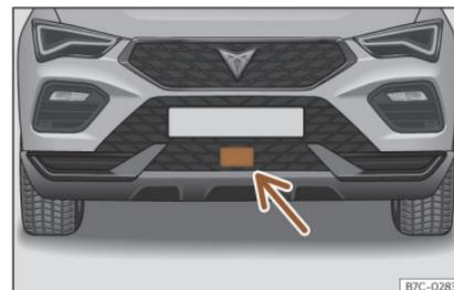
**Fig. 145** En el paragolpes delantero: sensor de radar.
