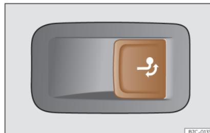
**Fig. 191** En el lado derecho del maletero: tecla para desbloquear el gancho de remolque.
