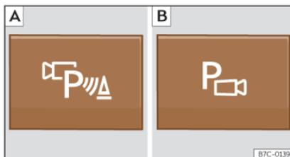
**Fig. 187** Consola central: tecla para activar/desactivar manualmente el sistema de visión periférica cuando está en combinación con el sistema de aparcamiento asistido (A) o bien con el sistema Park Pilot trasero (B).
