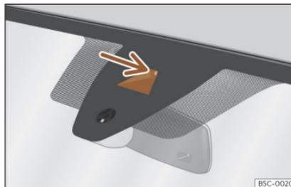
**Fig. 147** En el parabrisas: área de campo visual del sistema de aviso de salida del carril.
