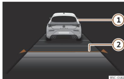
**Fig. 157** En la pantalla del cuadro de instrumentos: ACC activo.
