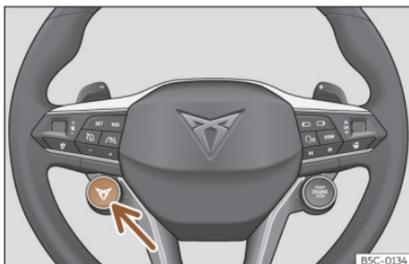
**Fig. 144** Volante multifunción: botón para cambiar el perfil de conducción.
