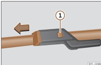
**Fig. 38** Cambio de las escobillas del limpiaparabrisas.
