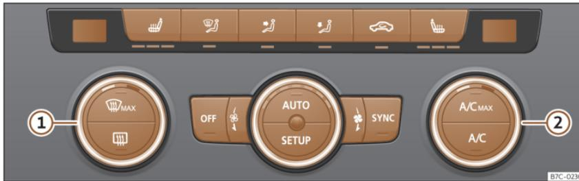
**Fig. 125** En la consola central: mandos del Climatronic.
