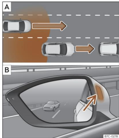
**Fig. 167** Representación esquemática: **A** Situación en un adelantamiento con tráfico en la parte trasera. **B** Indicación del asistente de cambio de carril en el retrovisor exterior izquierdo.
