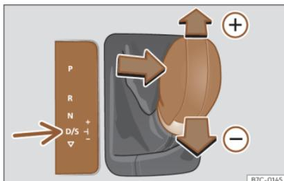
**Fig. 140** Consola central: cambiar con tiptronic.
