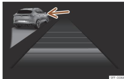
**Fig. 158** En la pantalla del cuadro de instrumentos: ACC activo, vehículo detectado por la izquierda
