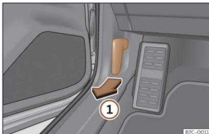
**Fig. 195** Palanca de desbloqueo en el espacio reposapiés del conductor.
