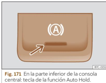
**Fig. 171** En la parte inferior de la consola central: tecla de la función Auto Hold.
