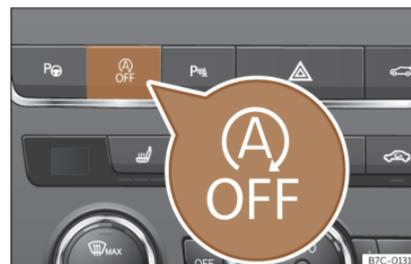
Fig. 138 Consola central: tecla del sistema Start-Stop.
