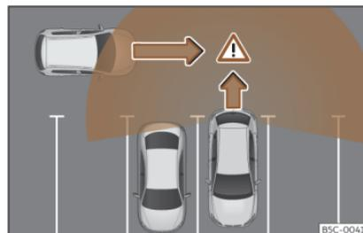
**Fig. 169** Representación esquemática del asistente de desaparcamiento: zona vigilada alrededor del vehículo que está desaparcando.
