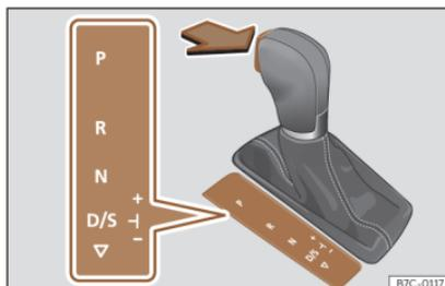
Fig. 139 Bloqueo de la palanca selectora.
