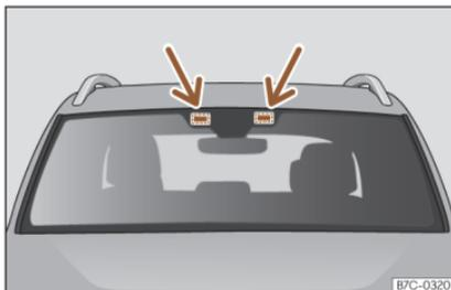
**Fig. 127** Zonas para la ubicación accesorios electrónicos
