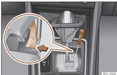
**Fig. 142** Palanca selectora: desbloqueo de emergencia en la posición de aparcamiento.
