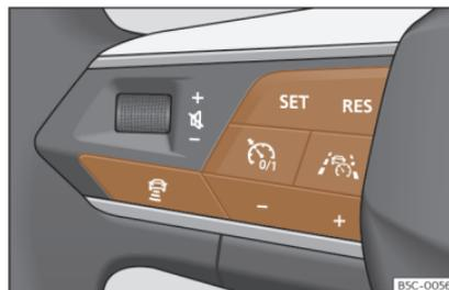
**Fig. 164** Lado izquierdo del volante multifunción: teclas para el manejo del Travel Assist.
