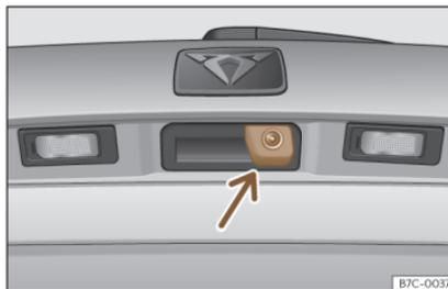
**Fig. 150** En la manecilla del portón trasero: cámara de visión periférica.
