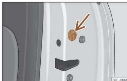
**Fig. 75** Bloqueo de emergencia de la puerta.
