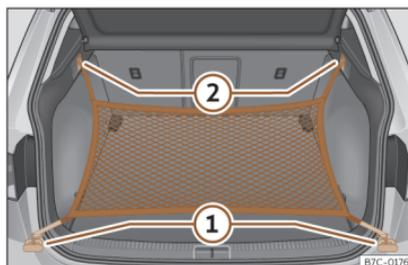
**Fig. 114** En el maletero: argollas ① y ganchos ② para enganchar la bolsa de red.
