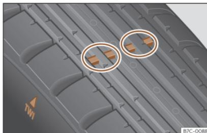
**Fig. 208** Perfil del neumático: indicadores de desgaste.
