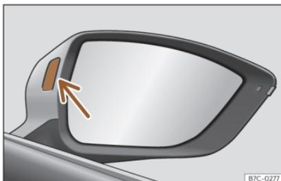
**Fig. 166** Testigo de control del asistente de cambio de carril.
