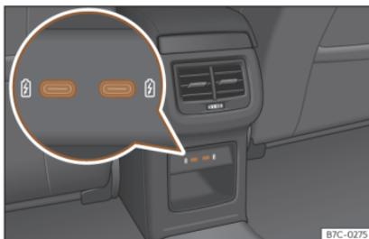
**Fig. 135** Parte posterior consola central: conectores USB con función de toma de corriente.
