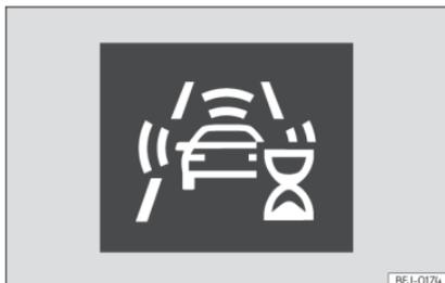
**Fig. 155** En la pantalla del cuadro de instrumentos: indicación de autocalibración inicial del sistema.
