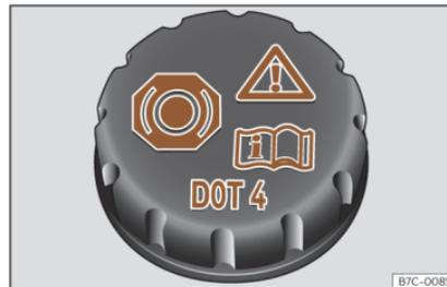
**Fig. 204** Vano motor: tapón del depósito del líquido de frenos.
