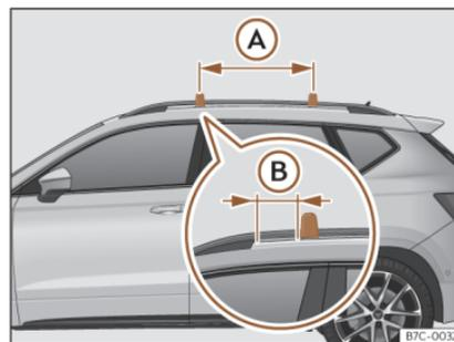
**Fig. 119** Puntos de fijación de las barras longitudinales para el portaequipajes del techo.
