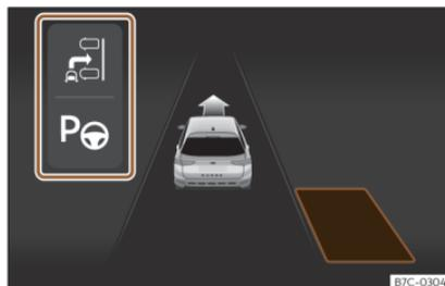
**Fig. 174** En la pantalla del cuadro de instrumentos: visualización del sistema de aparcamiento asistido con visualización reducida.
