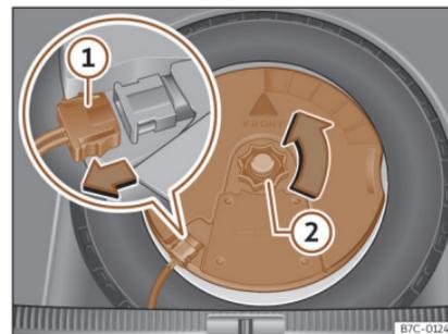
**Fig. 212** En el maletero: desmontar el subwoofer.
