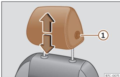
**Fig. 98** Asiento delantero: regulación del apoyacabezas.
