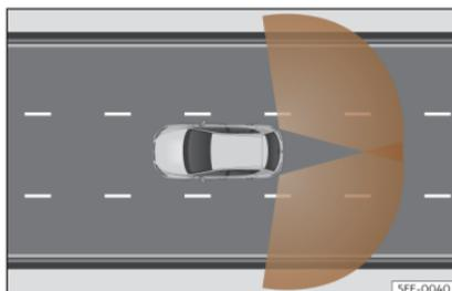
**Fig. 149** Zonas de detección de los sensores
