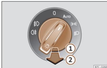
Fig. 88 Tablero de instrumentos: mando de las luces.
