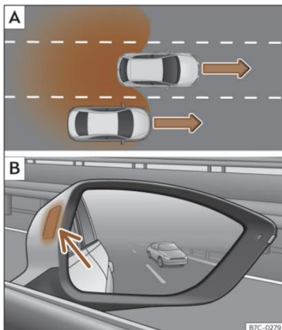
**Fig. 168** Representación esquemática: **A**) Situación en un adelantamiento e incorporación posterior al carril derecho. **B**) Indicación del asistente de cambio de carril en el retrovisor exterior derecho.
