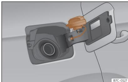
**Fig. 193** Tapa del depósito con el tapón encajado.
