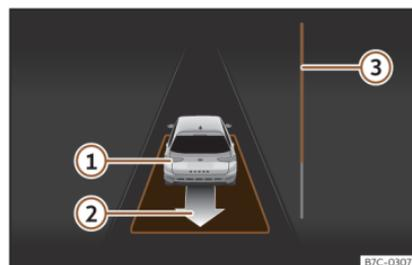
**Fig. 178** En la pantalla del cuadro de instrumentos: desaparcar de un hueco en línea.
