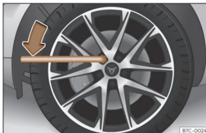
**Fig. 34** Cambio de rueda: aflojar los tornillos de rueda.
