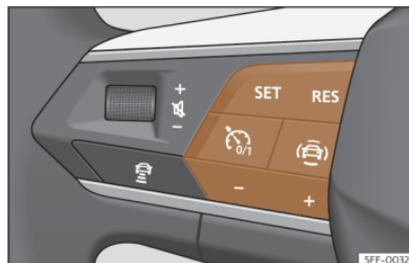
Fig. 151 En el volante multifunción: botones para manejar el regulador de velocidad
