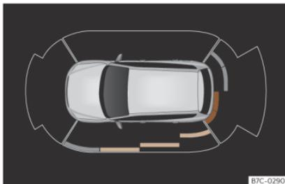
**Fig. 181** Visualización de ayuda al aparcamiento en la pantalla del sistema de infotainment.
