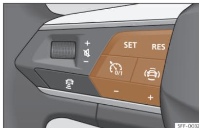
Fig. 152 En el volante multifunción: botones para manejar el limitador de velocidad
