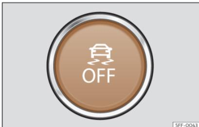
**Fig. 172** En la parte inferior de la consola central: botón para conectar/desconectar el ESC
