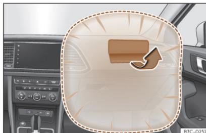
Fig. 14 Airbag del acompañante en el tablero de instrumentos.
