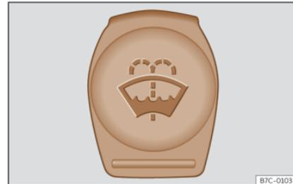
**Fig. 205** En el vano motor: tapón de color azul del depósito del limpiacristales.
