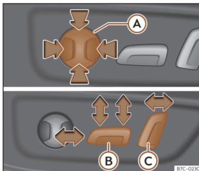
Fig. 97 Asiento del conductor: ajuste eléctrico del asiento.
