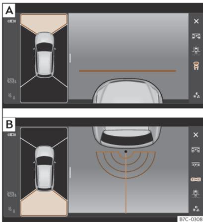
**Fig. 188** Visualización en la pantalla del sistema de visión periférica: **A**) Cámara delantera: vista campo a través. **B**) Cámara trasera: vista campo a través.
