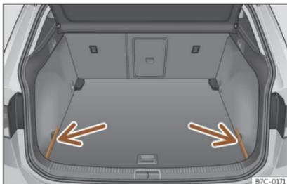
**Fig. 108** En el maletero: tapas para guardar la bandeja.
