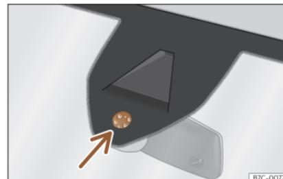
**Fig. 93** Superficie sensible del sensor de lluvia.
