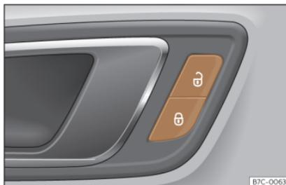
**Fig. 70** Puerta del conductor: conmutador del cierre centralizado.
