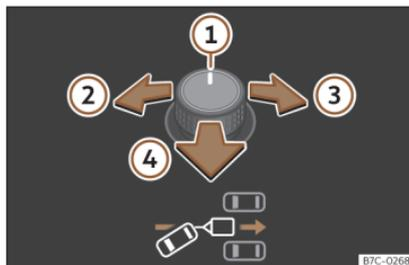
**Fig. 184** Mando giratorio de los retrovisores exteriores: ajustar el ángulo del remolque.
