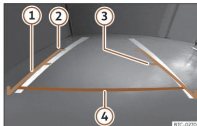
**Fig. 189** Pantalla del sistema de infotainment: líneas de orientación.
