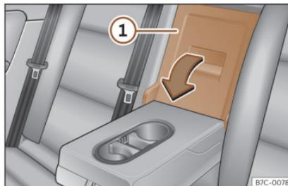
**Fig. 116** En el respaldo del asiento trasero: apertura de la trampilla.
