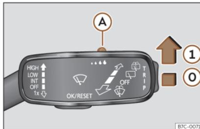
**Fig. 92** Palanca del limpiaparabrisas: ajustar el sensor de lluvia **A**.
