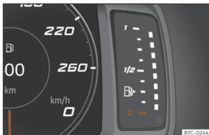
Fig. 54 Indicador del nivel de combustible.
