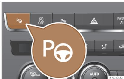
**Fig. 173** En la parte superior de la consola central: tecla para conectar el sistema de aparcamiento asistido.
