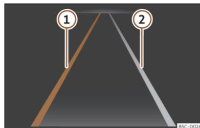
**Fig. 161** En la pantalla del cuadro de instrumentos: indicaciones del sistema de aviso de salida del carril.
