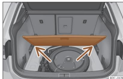
**Fig. 111** Suelo variable del maletero: posición inclinada.
