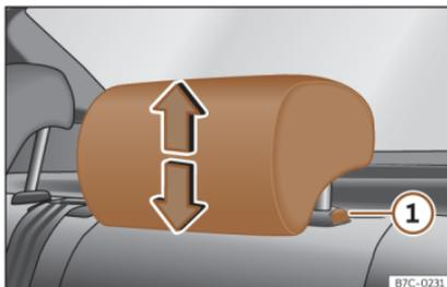
**Fig. 99** Apoyacabezas trasero: regulación del apoyacabezas.
