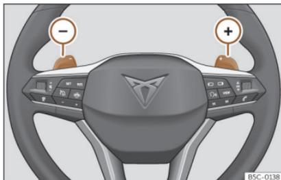
**Fig. 141** Volante: palancas para cambio automático.
