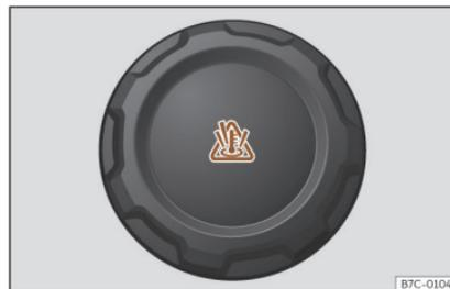
Fig. 203 Vano motor: tapón del depósito de expansión del líquido refrigerante.
