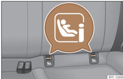
**Fig. 25** Asiento trasero: anillas de sujeción ISOFIX/i-Size.
