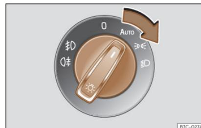
**Fig. 87** Tablero de instrumentos: mando de las luces.
