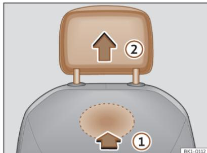
**Fig. 100** Apoyacabezas delantero: desmontaje.
