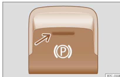
**Fig. 170** En la parte inferior de la consola central: tecla del freno de estacionamiento electrónico.
