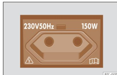
**Fig. 124** En el lado izquierdo del maletero: toma de corriente de 230 voltios.
