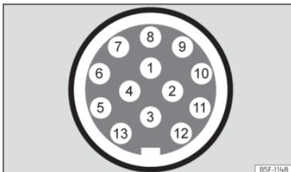
**Fig. 190** Representación esquemática: asignación de los pines de la toma de corriente para remolque.
