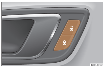
Fig. 70 Puerta del conductor: conmutador del cierre centralizado.
