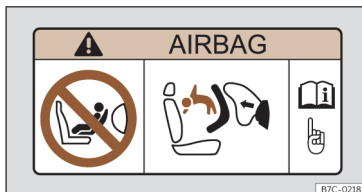
Fig. 23 Adhesivo del airbag: en el parasol del lado del acompañante
