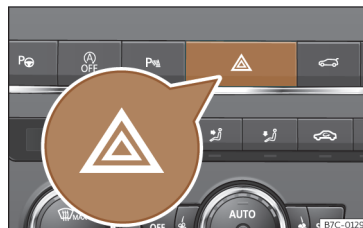
Fig. 90 Tablero de instrumentos: conmutador de los intermitentes de emergencia.
