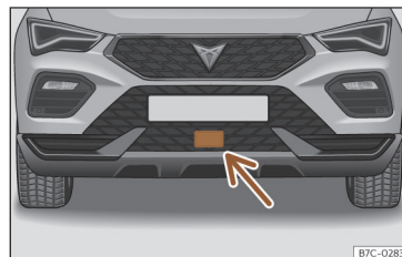
Fig. 143 En el paragolpes delantero: sensor de radar.
