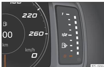
Fig. 54 Indicador del nivel de combustible.
