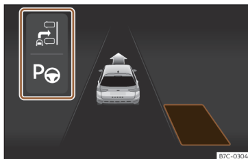
Fig. 171 En la pantalla del cuadro de instrumentos: visualización del sistema de aparcamiento asistido con visualización reducida.
