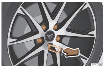
Fig. 32 Rueda: tornillos de la rueda con capuchones.
