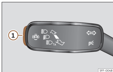
Fig. 57 En la palanca de intermitentes y de luz de carretera: tecla para los sistemas de asistencia al conductor (según versiones).
