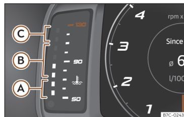
Fig. 55 Indicador de temperatura del líquido refrigerante del motor.
