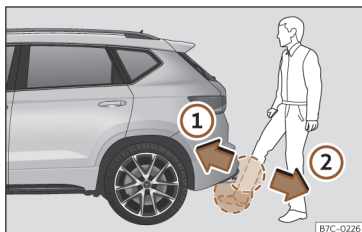
Fig. 80 Portón del maletero con apertura controlada por sensor (Easy Open).
