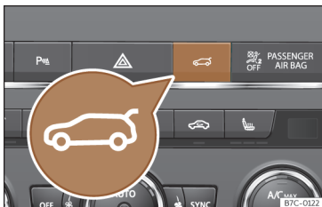
Fig. 79 Consola central: tecla para abrir y cerrar el portón trasero.
