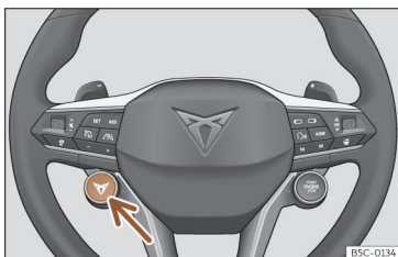
Fig. 142 Volante multifunción: botón para cambiar el perfil de conducción.
