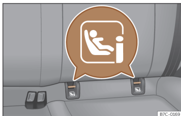
Fig. 25 Asiento trasero: anillas de sujeción ISOFIX/i-Size.
