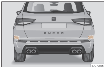
Fig. 146 Vista trasera del vehículo: zonas de los sensores de radar.
