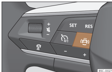
Fig. 58 Lado izquierdo del volante multifunción: tecla para los sistemas de asistencia al conductor (según versiones).
