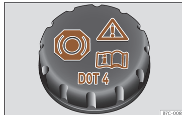
Fig. 201 Vano motor: tapón del depósito del líquido de frenos.
