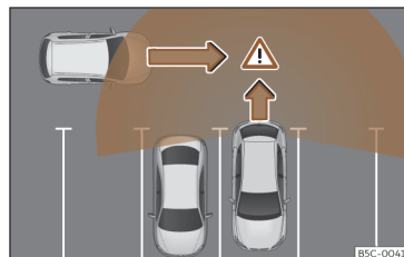
Fig. 167 Representación esquemática del asistente de desaparcamiento: zona vigilada alrededor del vehículo que está desaparcando.
