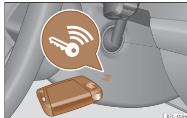
Fig. 135 A la derecha de la columna de dirección: arranque de emergencia.
