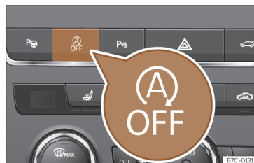
Fig. 136 Consola central: tecla del sistema Start-Stop.
