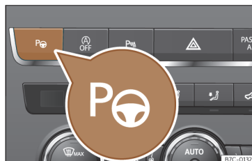
Fig. 170 En la parte superior de la consola central: tecla para conectar el sistema de aparcamiento asistido.
