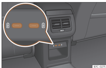
Fig. 133 Parte posterior consola central: conectores USB con función de toma de corriente.
