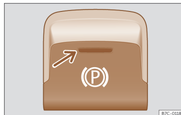
Fig. 168 En la parte inferior de la consola central: tecla del freno de estacionamiento electrónico.
