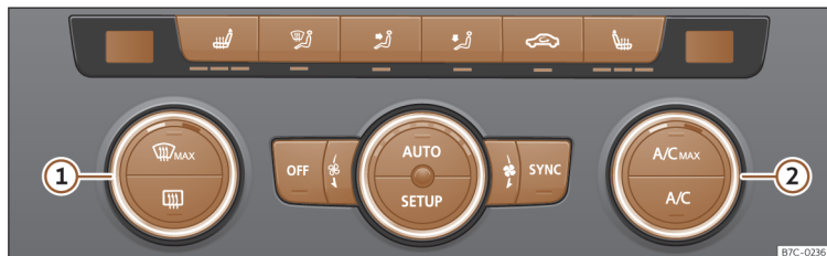
Fig. 124 En la consola central: mandos del Climatronic.
