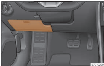
Fig. 187 No taboleiro de instrumentos do lado do condutor: tapa da caixa de fusibles.
