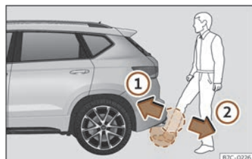
Fig. 57 Portón do maleteiro con apertura controlada por sensor (Easy Open).
