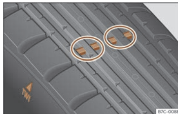
Fig. 203 Perfil do pneumático: indicadores de desgaste.
