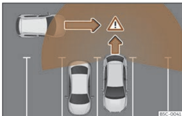
Fig. 143 Representación esquemática do asistente de desaparcamento: área vixiada en torno ao vehículo que está a desaparcarse.
