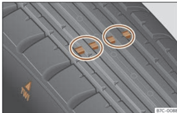
203. irudia Pneumatikoaren profila: higadura-adierazleak.
