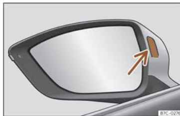
120. irudia Errei-aldaketarako laguntzailearen kontrol-argia.
