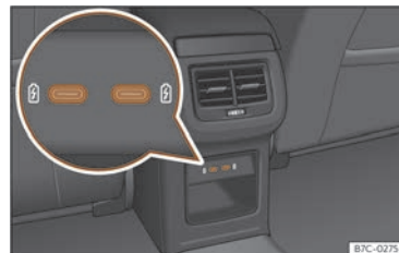
150. irudia Erdiko konsolaren atzealdean: korrante-harguneko funtzioa duten USB konektoreak
