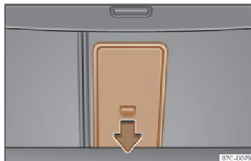
169. irudia Maletategian: tranpa-oholaren irekiera.
