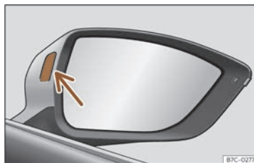
121. irudia Errei-aldaketarako laguntzailearen kontrol-argia.
