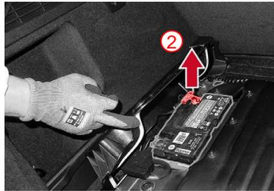
**Separar de la estación de carga (Desbloqueo de emergencia)**
